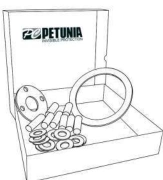
در محل های جدا سازی خطوط لوله زیر زمینی (UG) و رو زمینی (AG) با هدف جلوگیری از نشت جریان حفاظت کاتدی لازم است در محل فلنچ ها از تجهیزات عایق سازی الکتریکی استفاده گردد. یکی از پرکاربردترین این تجهیزات، کیت های عایقی هستند که شامل قطعات زیر است:
